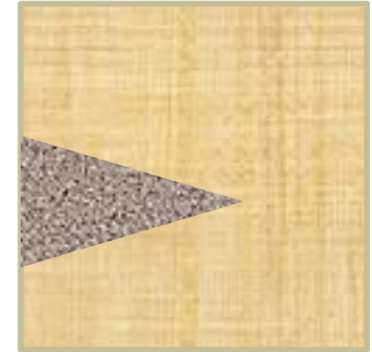
FRACTURE MAINTENUE OUVERTE PAR SABLE
