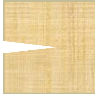
FRACTURE SE REFERMANT SUITE ARRÊT POMPAGE
